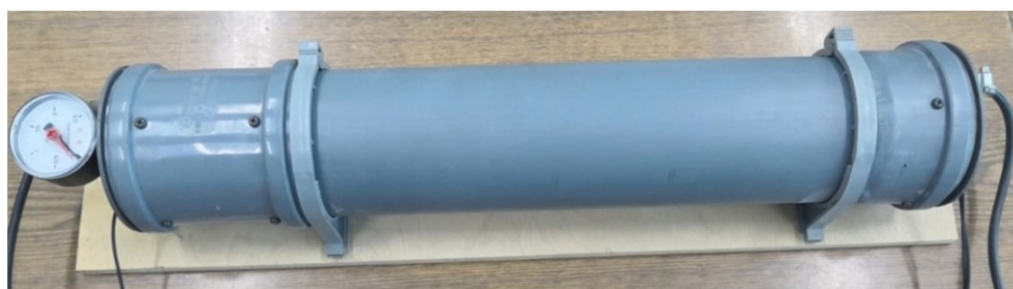
Рисунок 4 – Озонатор для обеззараживания пчелиных ульев, используемый в исследованиях
