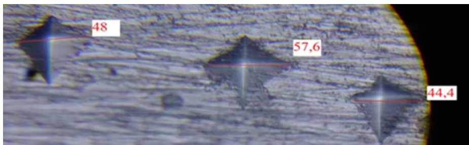
Рисунок 1 – Металлические образцы после процедуры индентирования отражают характерный след алмазной пирамидки на исследуемой поверхности материала
