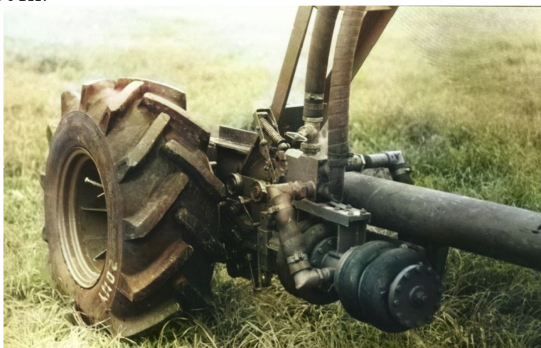
Рисунок 4 – Сильфольный гидропривод дождевальной машины
