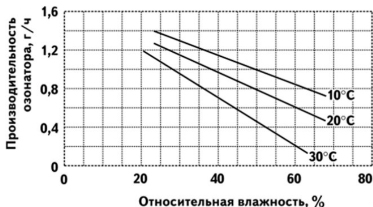
Рисунок 2 – Зависимость производительности электроозонатора от влажности и температуры воздуха
