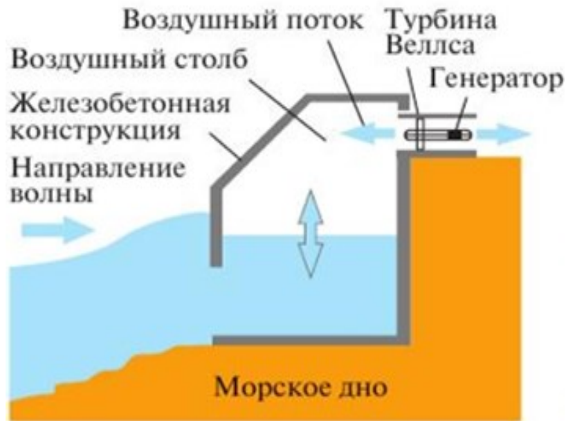
Рисунок 1 – Вариант конструкции приливной электростанции с использованием турбины
