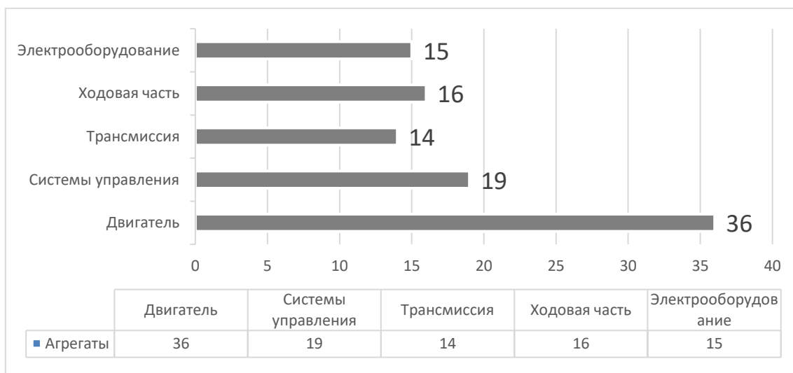
Рисунок 3 – Распределение отказов тракторов АПК по техническим объектам
