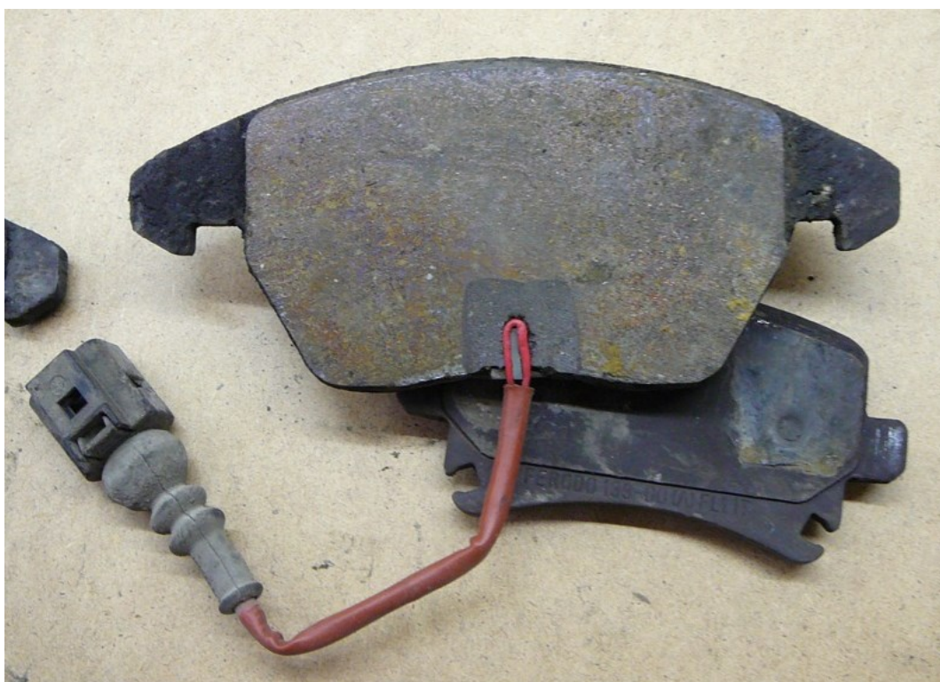
Рисунок 2 – Пример тормозной колодки с датчиком износа накладки
