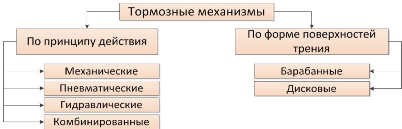
Рисунок 1 – Классификация тормозных систем по принципу действия
