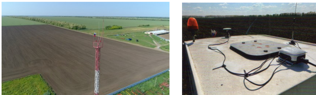
Рисунок 3 – RTK-станция, навигационный контроллер и антенна
