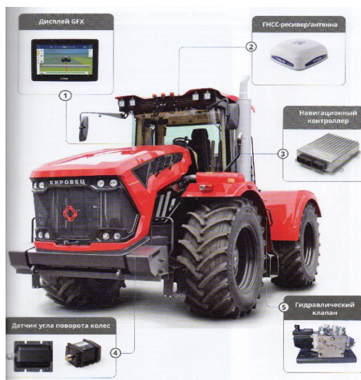
Рисунок 4 – Схема установленного автопилота на примере трактора «Кировец К-7М»
