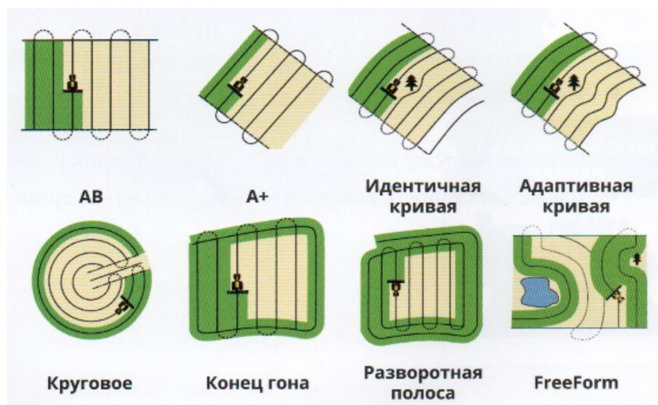
Рисунок 2 – Способы движения современных беспилотных тракторов
