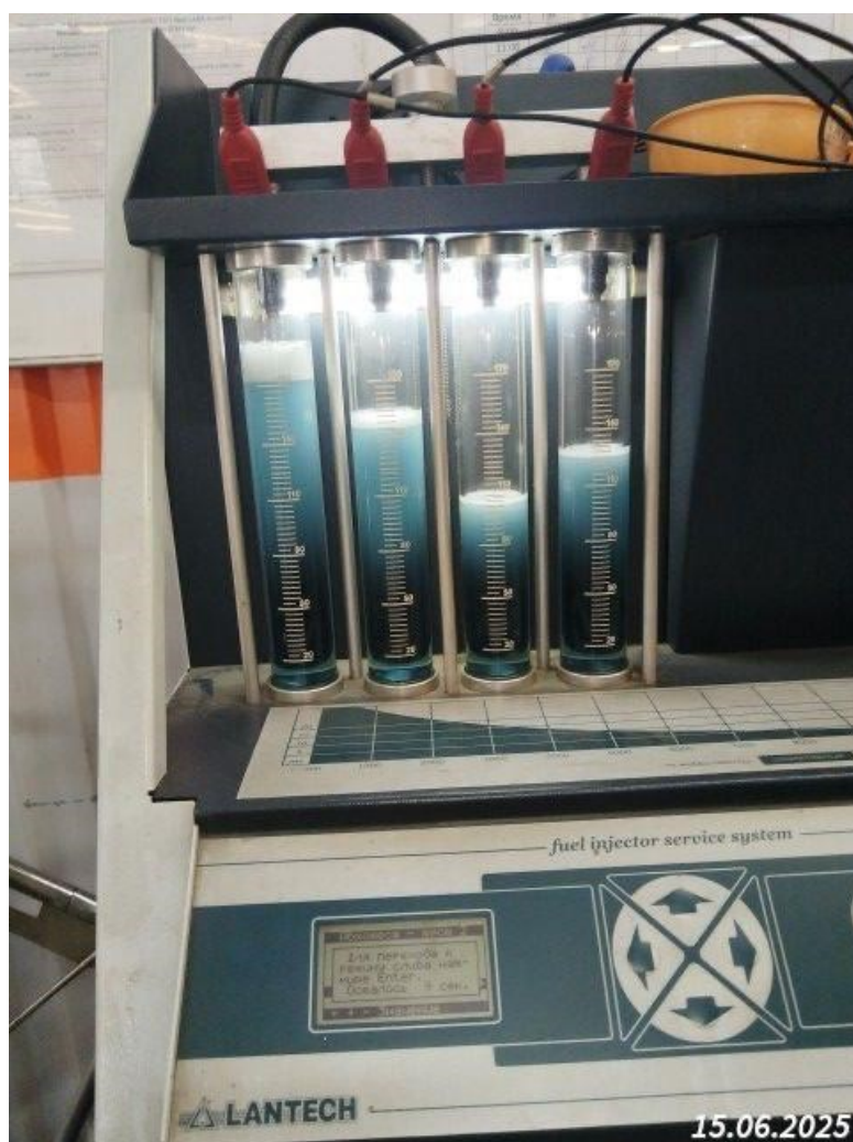
Рисунок 3 – Тест топливных форсунок на стенде
