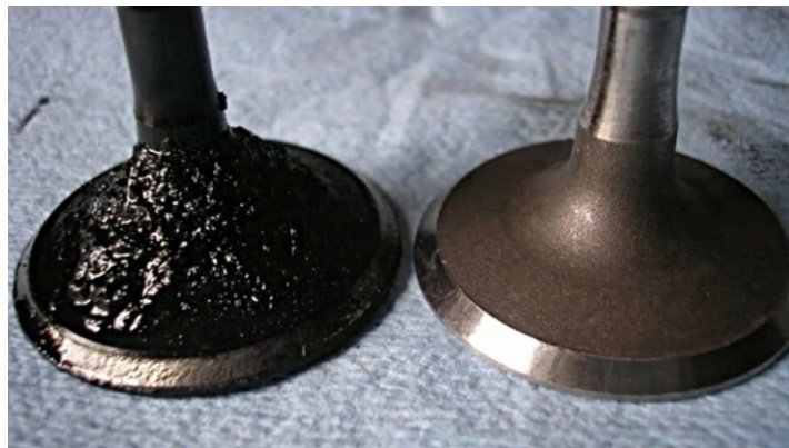
Рисунок 1 – Слева изображён клапан с отложениями, справа – исправный клапан [2]
