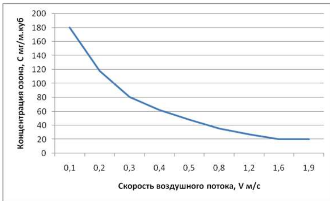
Рисунок 3 – График зависимости концентрации озона от скорости движения воздуха в озонаторной камере
