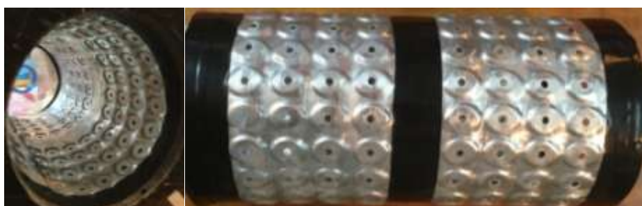
Рисунок 8 – Сепарирующая поверхность (решето с ячейками)
