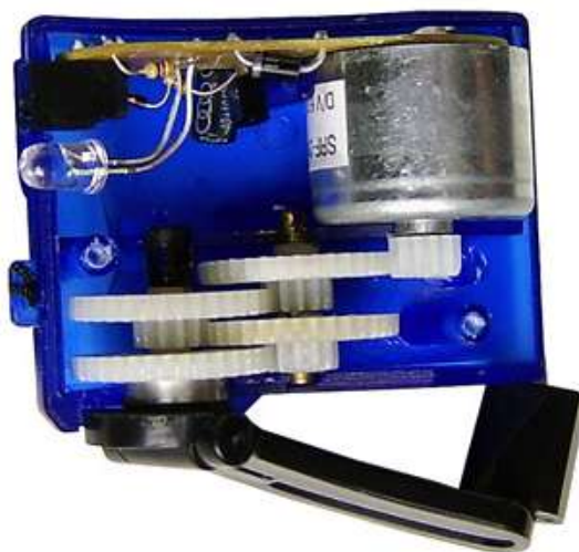
Рисунок 6 – Конструкция зарядного устройства
