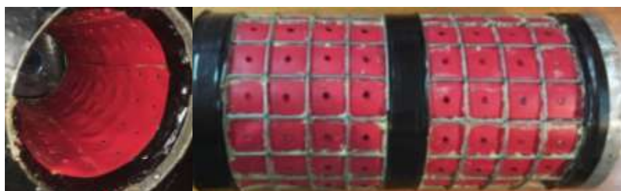
Рисунок 9 – Сепарирующая поверхность (резиновое решето с ячейками)
