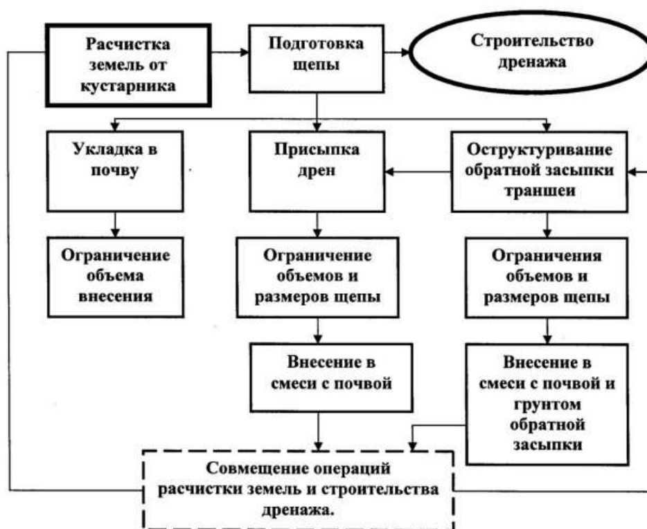
Рисунок 3 – схема увязки процессов строительства дренажной системы и расчистки земель
