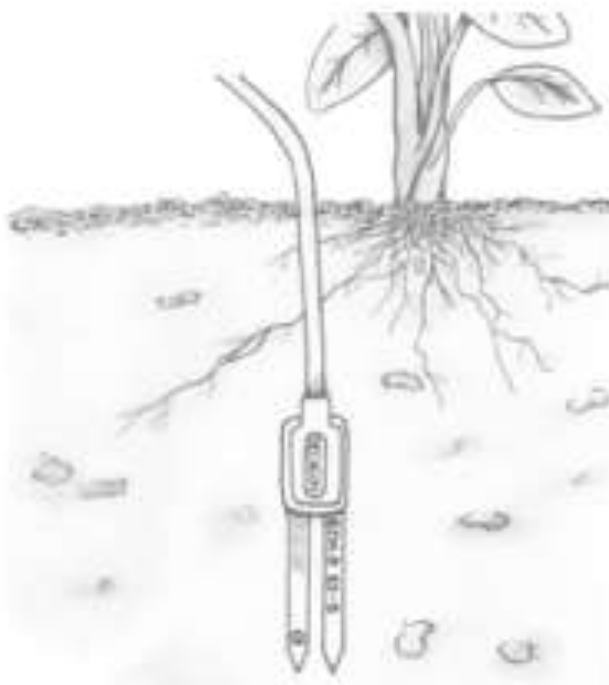
Рисунок 2 – Схема измерения влажности почвы
