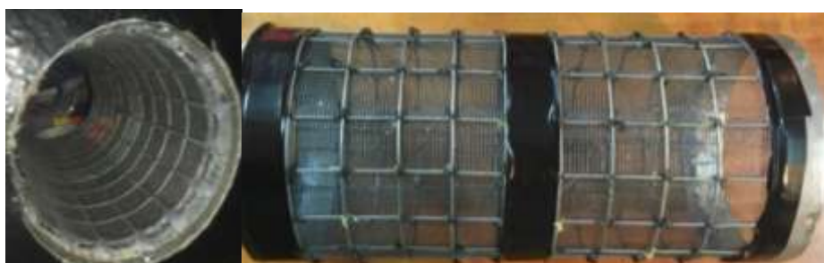
Рисунок 7 – Сетчатая сепарирующая поверхность
