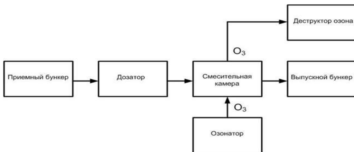
Рисунок 1 – Функциональная схема озонаторной установки
