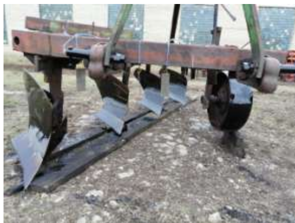
Рисунок 1 – Плуг ПЛН-4-35 и образцы из углеродистой стали после обработки исследуемым антикоррозионным составом
