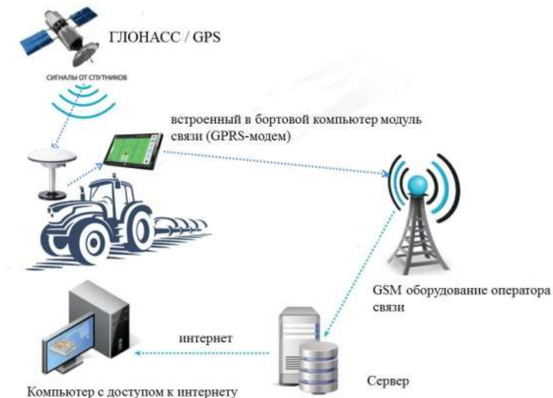
Рисунок 1 – Общая схема устройства системы мониторинга техники
