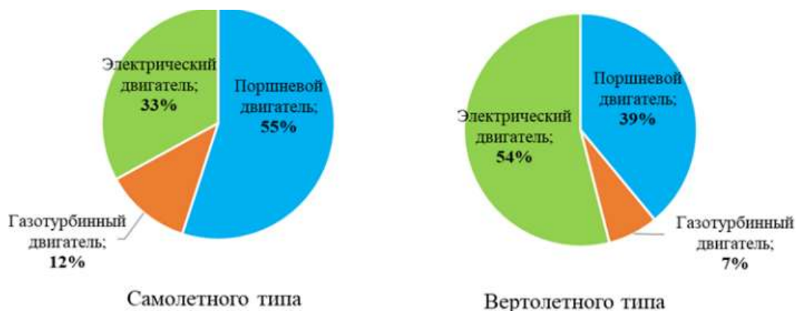
Рисунок 2 – Классификация БПЛА по виду двигателя
