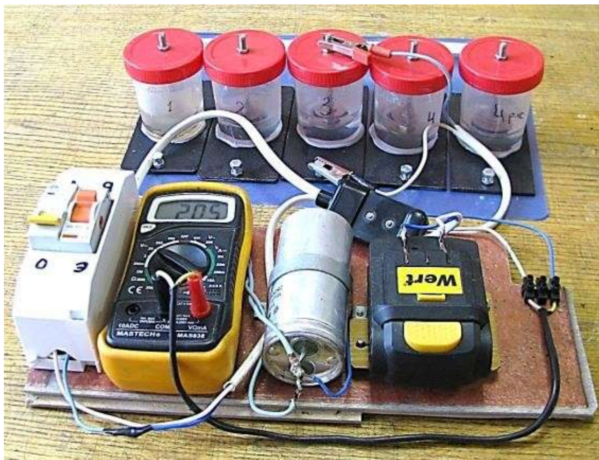
Рисунок 1 – Измерительный комплект ИКС-1 для испытаний покрытий в растворе минерального удобрения
