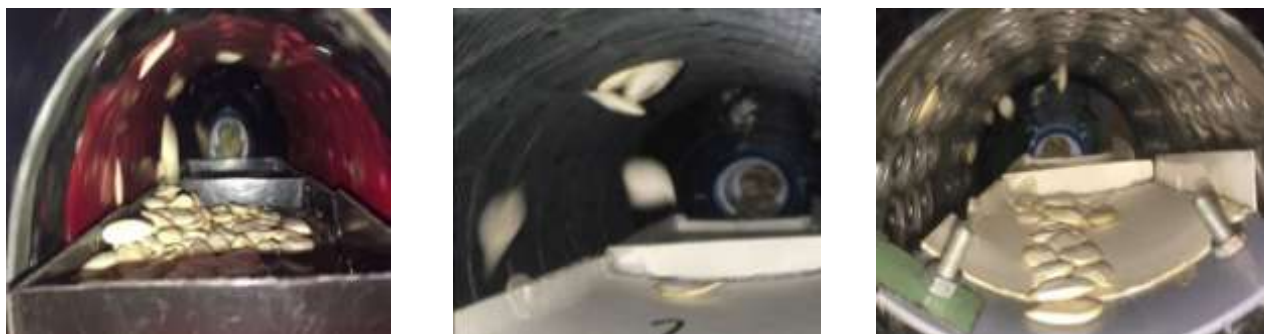
Рисунок 10 – Разделение семян решетом с ячейками, сетчатой поверхностью и резиновым решетом с ячейками
