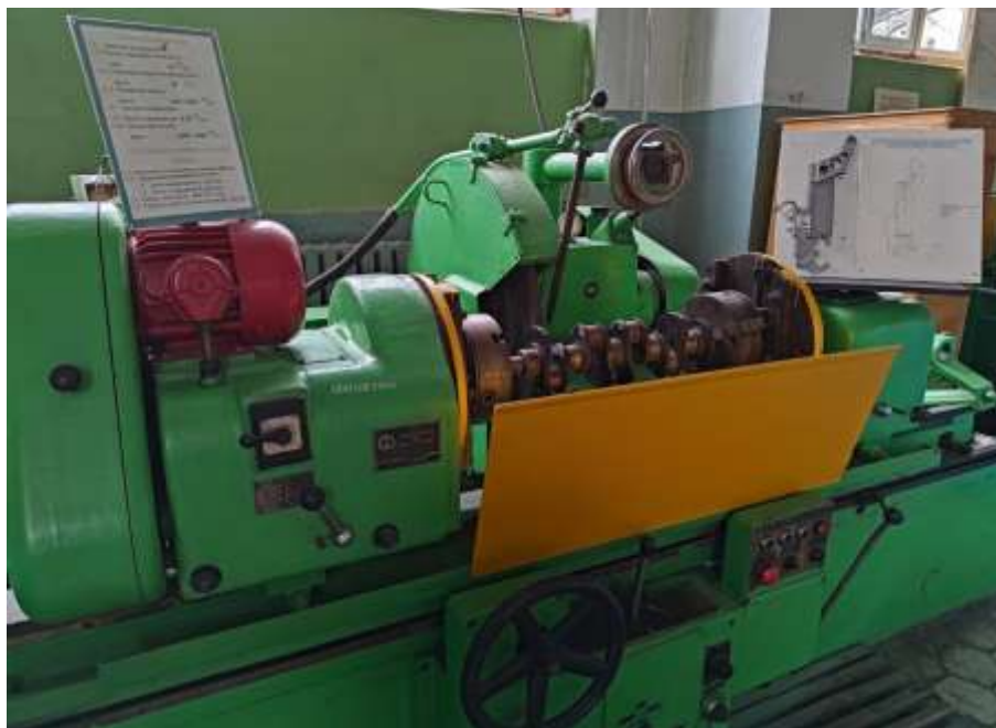
Рисунок 3 – Кругло-шлифовальный станок модели 3А423 с макетом навесной модернизированной скобы
