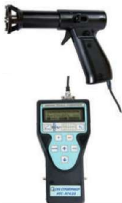
Рисунок 4 – Измеритель прочности бетона ИПС-МГ4.01 [6]
