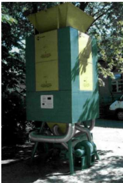
Рисунок 2 – Микроволновая электроустановка для обработки семенного материала с помощью ЭМПСВЧ
