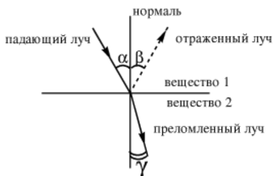
Рисунок 1 – Схема преломления света
