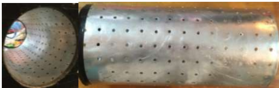
Рисунок 6 – Сепарирующая поверхность (ровное решето)
