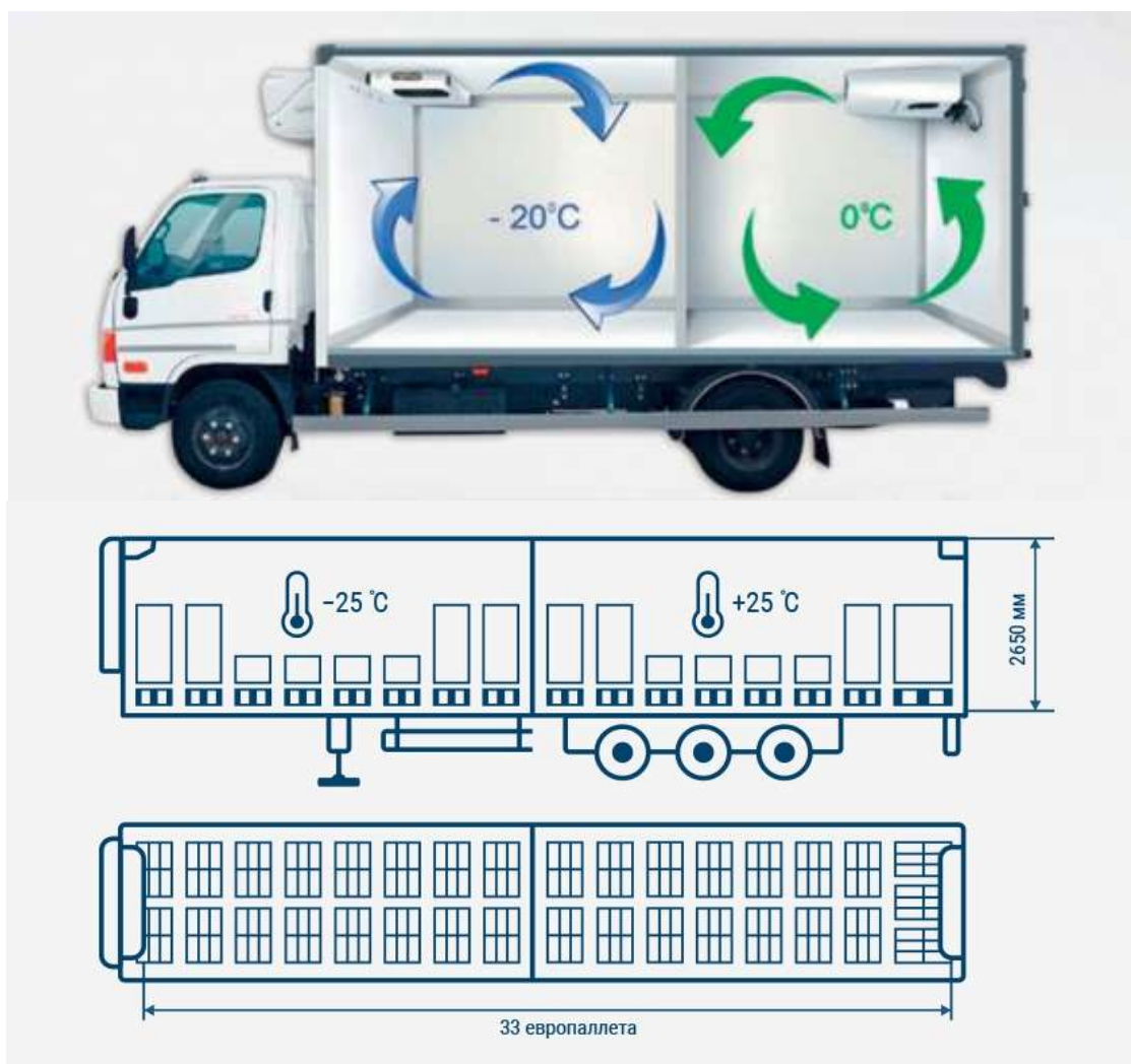
Рисунок 3 – Схема автомобиля-рефрижератора с двухзонным кузовом
