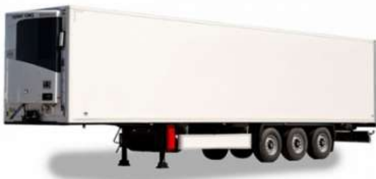
Рисунок 2 – Схема полуприцепа-рефрижератора UAT-SRGB-8728.01
