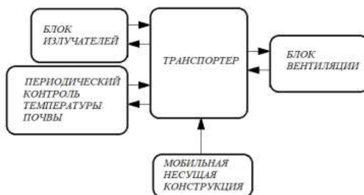
Рисунок 4 – Структурная схема мобильной машины для обеззараживания почвы
