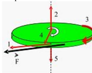
Колесо вращается так, как показано на рисунке белой стрелкой. К ободу колеса приложена сила, направленная по касательной. Правильно изображает угловое ускорение колеса вектор ...
