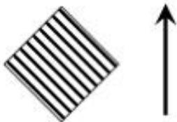
На борту космического корабля нанесена эмблема в виде геометрической фигуры. Из-за релятивистского сокращения длины эта фигура изменяет свою форму. Если корабль движется в направлении, указанном на рисунке стрелкой, со скоростью, сравнимой со скоростью света, то в неподвижной системе отсчета эмблема примет форму, указанную на рисунке ...
