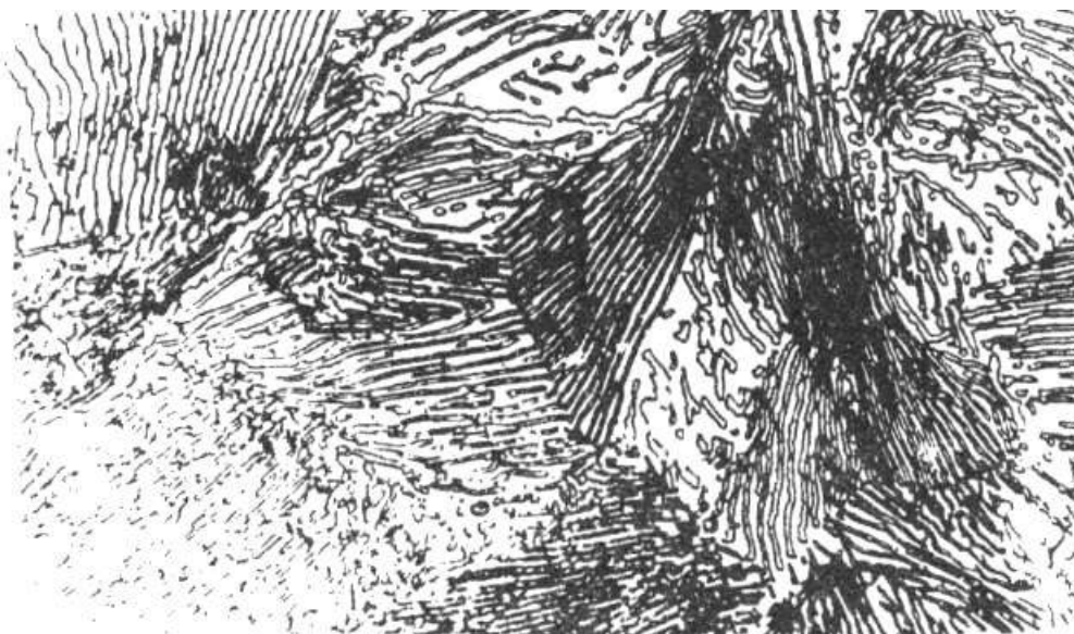
Рисунок 8.2. Микроструктура пластинчатого перлита x500
