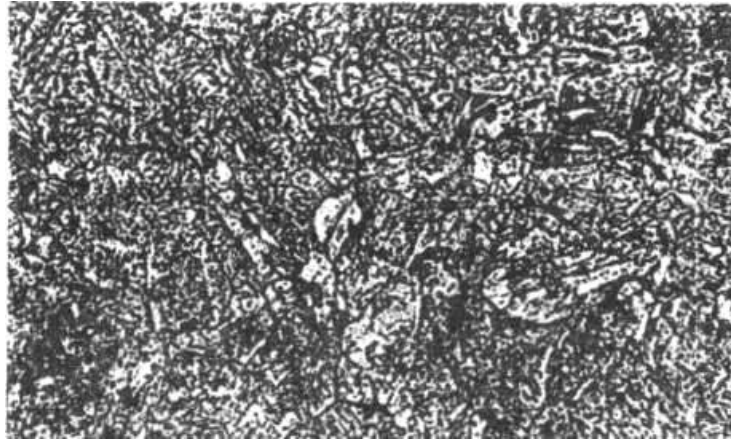
Рисунок 8.8. Микроструктура мартенсита и участков карбидов x200
