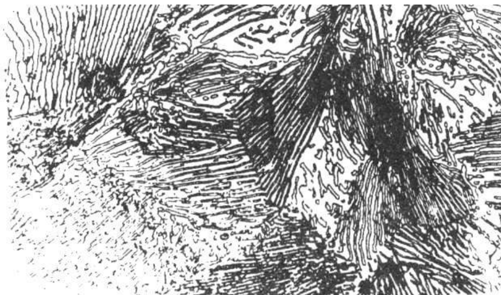
Рисунок 8.2. Микроструктура пластинчатого перлита x500
