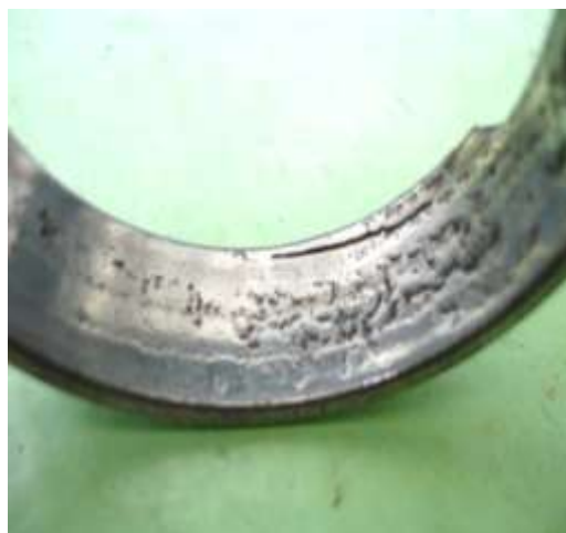
а – шестерня к.п.п.; б – шейка распредвала; в – кольцо подшипника. Рисунок 1.11 – Детали, подвергшиеся усталостному изнашиванию.
