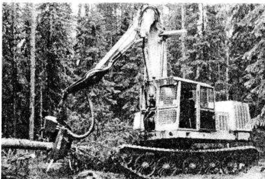
Рис. 2.37. Валочно-сучкорезно-раскряжевальная машина (харвестер) с сучкорезной головкой КЕТО-150
