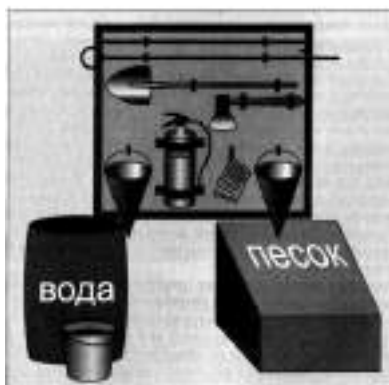
Рисунок 1. Пожарный щит первичных средств пожаротушения
