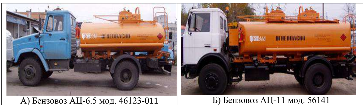
Рисунок 2.5 – Бензовозы: А) Бензовоз АЦ-6.5 мод. 46123-011 на шасси ЗИЛ-433362; Б) Бензовоз АЦ-11 мод. 56141 на шасси МАЗ-533702
