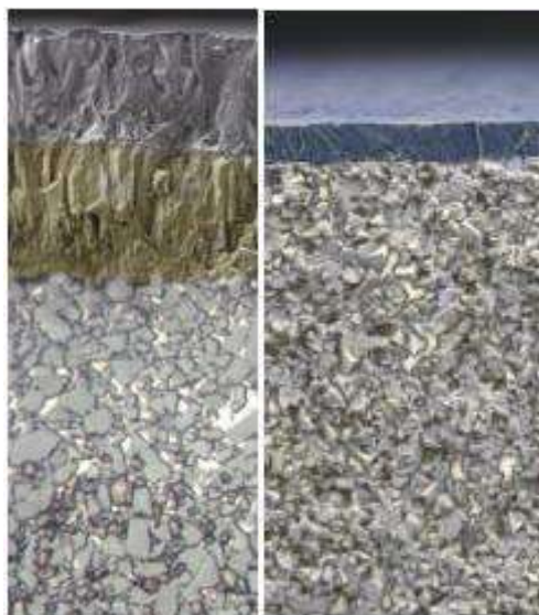
Рисунок 1. Внешний вид nano покрытий нанесенных по технологиям CVD и PVD
