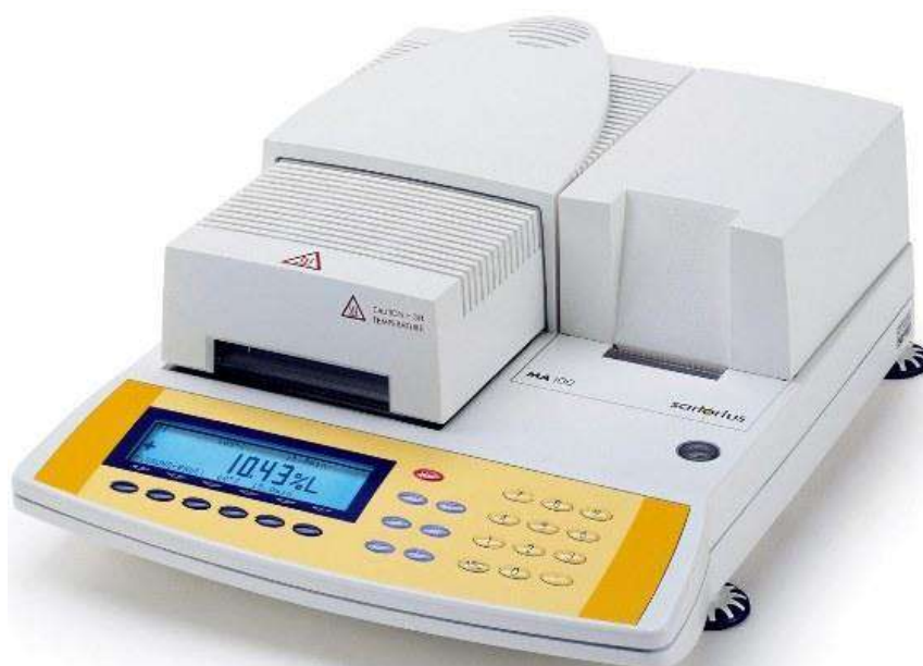
Рисунок 6.1.-Влагомер, работающий на принципе весового метода
