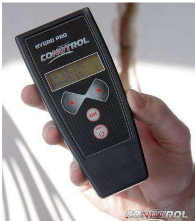
Рисунок 6.5.-Влагомер, работающий на принципе диэлькометрического метода
