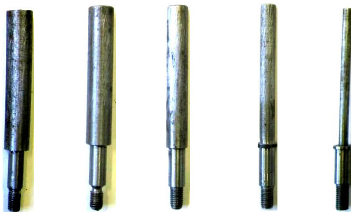
Рисунок 4.18 – Штифты измельчителя лабораторной установки
