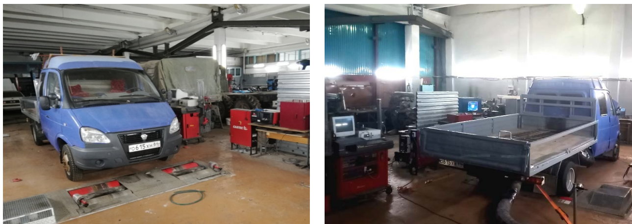
Рисунок 4. Стенд с беговыми барабанами и ГАЗ 27040V «Фермер».
